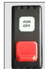
11 – Interruptor de desligamento ASR (regulagem antideslizamento)
