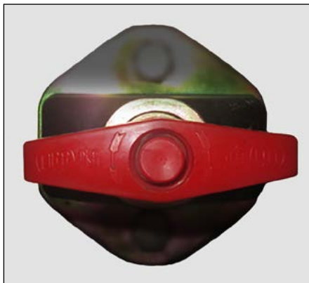
Interruptor de alimentação principal – posição ON (ligado)
