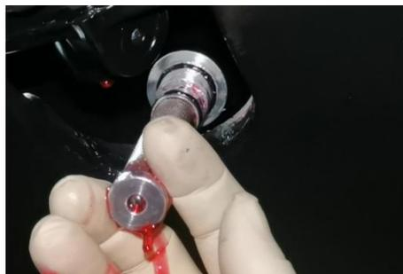
Durante o processo de desmontagem, não utilize ferramentas que girem muito rápido e não utilize um rotor eletrônico de alto torque. Solte o filtro de óleo em velocidade normal e lenta, retire-o do orifício do filtro de óleo na direção do eixo. Em seguida, retire-o verticalmente por cima ou por baixo, evitando danificar as peças e quebrar o filtro de óleo, que pode cair na passagem de óleo;
