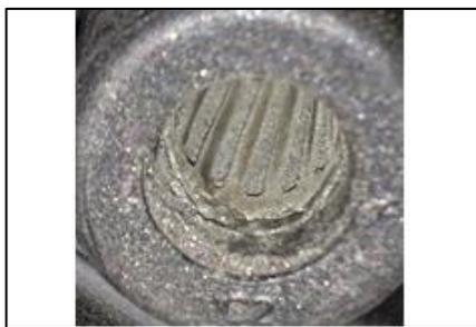
O terminal inclinou-se e deformou-se
