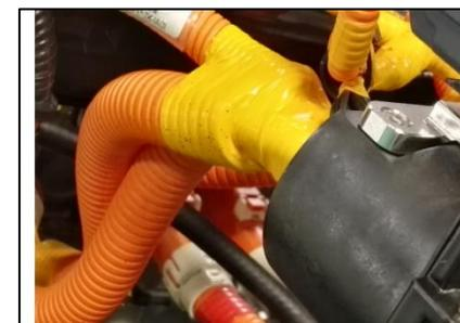
A camada externa dos cabos na extremidade da porta de carregamento está enegrecida
