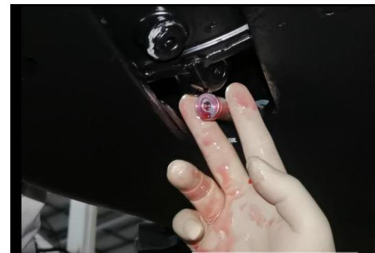
Etapa 2: Pré-aperte manualmente o filtro de óleo pela parte inferior da carcaça do eixo;
