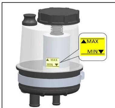
Depois de adicionar fluido de direção, se o nível do fluido de direção cair em um curto período de tempo, certifique-se de verificar se há algum vazamento de fluido hidráulico no local de estacionamento.
